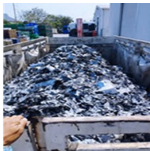
รูปเศษอลูมิเนียมที่ส่ง Remelt และ Ingot ที่กลับมาจากการ Remelt
